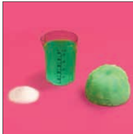
Superabsorber + Flüssigkeit = Gel
